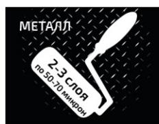
При защите металлических поверхностей мастики наносятся в два-три слоя при средней толщине каждого слоя 50-70 микрон.
